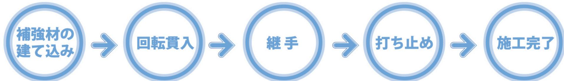
鋼管を建て込み、先端を杭芯にセットする。
